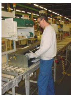
Установка змеевика внутри панели установки
